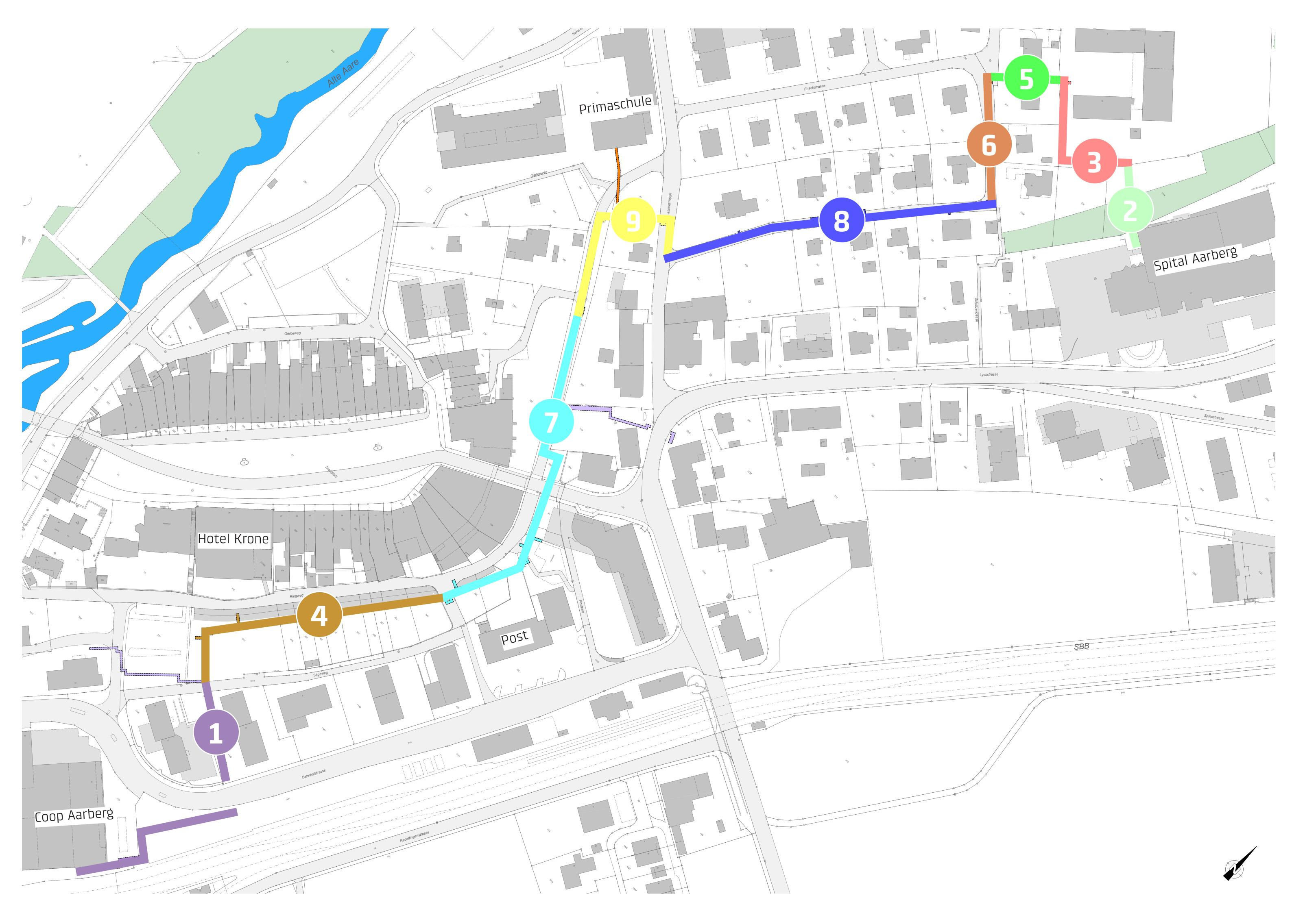
Neue Fernwärmeleitungen werden zwischen Coop und dem Spital Aarberg verlegt. Die Bauarbeiten beginnen gleichzeitig beim Coop und beim Spital Aarberg.
